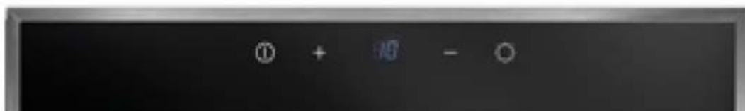
Желаемую температуру можно задать посредством нажатия кнопок «+» и «-».
