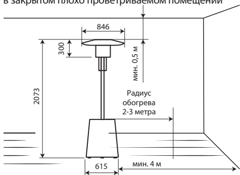
Рис. 1в – Размеры прибора и допуски (0,5 min)
