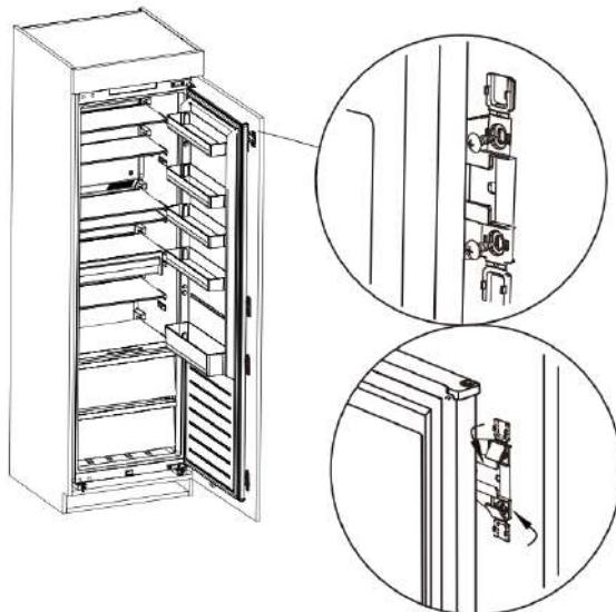
6. Установите уплотнительную прокладку в зазор между корпусом холодильника и шкафом.
